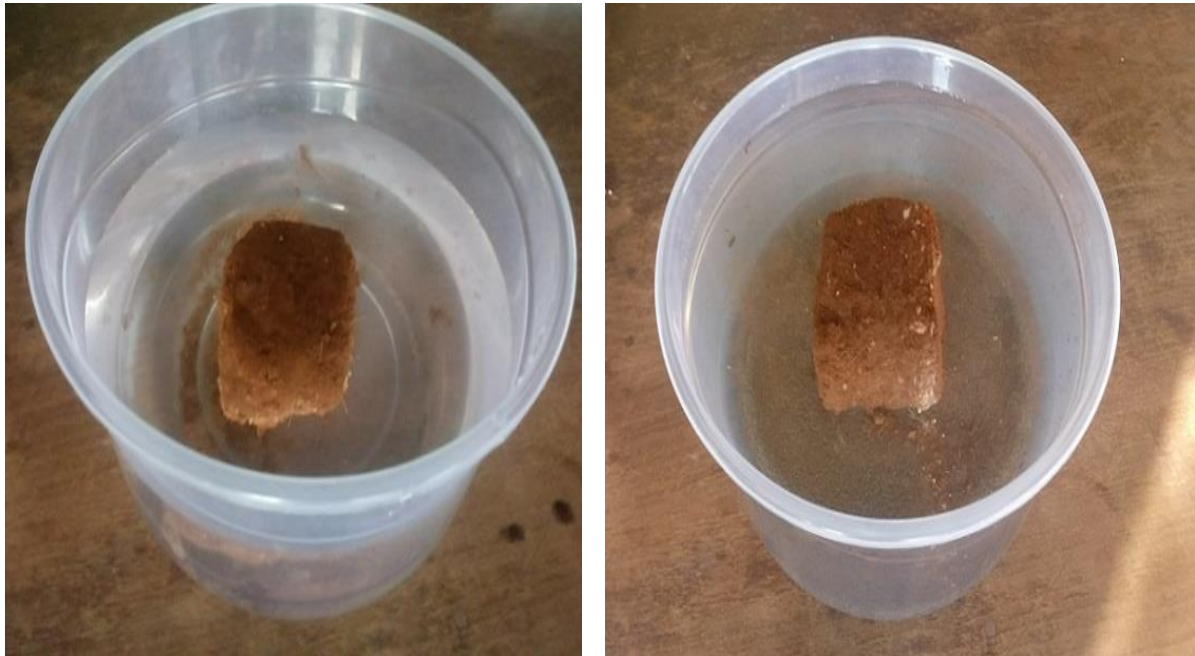
Figuras 7 e 8 – Ensaio de Desagregação: imersão total e parcial.
